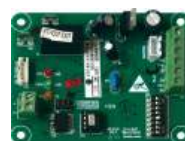
Согласователь работы двух кондиционеров YCJ-A002*
