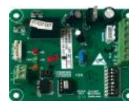
Согласователь работы двух кондиционеров YCJ-A002*
