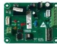
Согласователь работы двух кондиционеров YCJ-A002*
