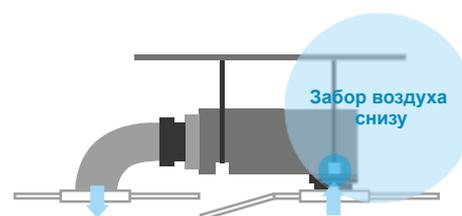
Два варианта забора воздуха из помещения обеспечивают удобство и гибкость монтажа
